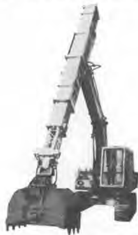
写真-4 レンタルのニッケン LA-15 TL 深掘りアームトラス型クラムシェル
