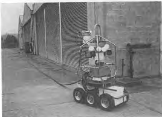
写真-5 監視ロボット（コードの延長先にモニタ装置がある）
