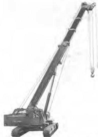
写真-5 石川島 CCH 500 T テレスコピッククローラクレーン
