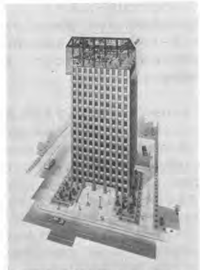
図-1 全自動ビル建設システム構想図
