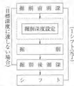
図-5 グラブ測深掘削フロー
