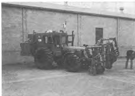
写真-6 埋設物探知ロボット（キャブ内にモニタ装置がある）
