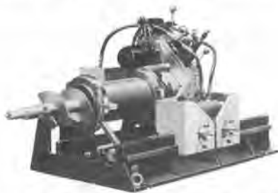
写真-6 小松 SR-18 S 取付管埋設機スピーダ
