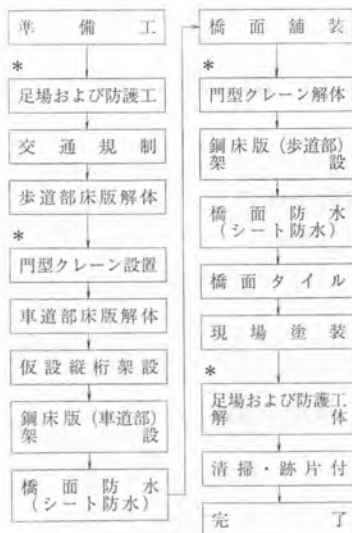
図—9 鋼床版の施工フロー図
