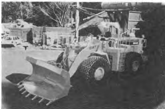
写真—4 サイドダンプ式ホイールローダ (3.3 m³)
