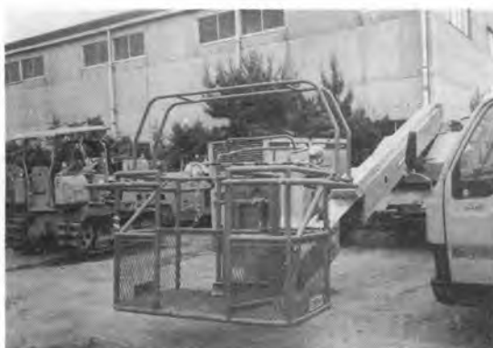
写真-20 高所作業車ヘッドガード例
