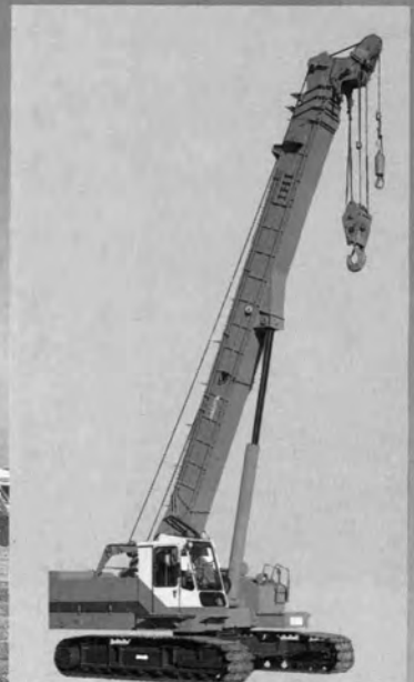
CCH500T テレスコピック クローラクレーン 石川島建機株式会社
