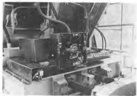
写真-4 エア自動供給装置
