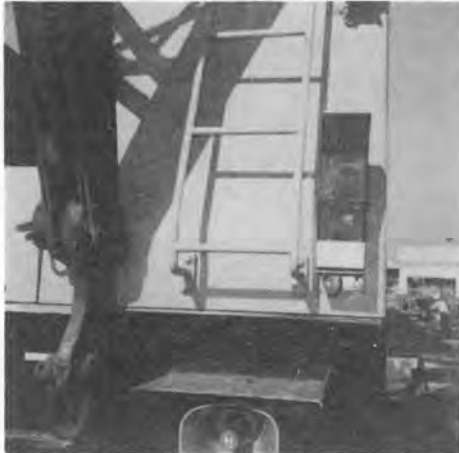
写真-11 荷重表示装置
