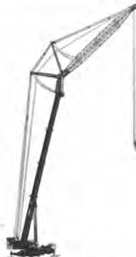
写真-5 タダノ TG-3600 M 油圧式トラッククレーン
