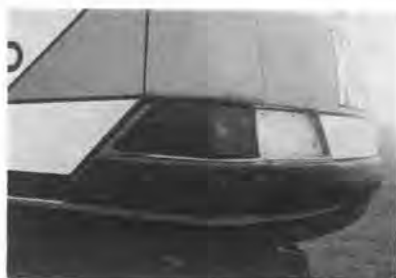
写真-1 バックホウの後方に取付けられる旋回警報フラッシュャ
