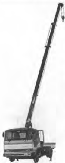
写真-6 前田 MC 375 トラック搭載型クレーン
