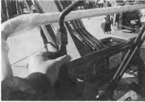
写真-4 レバー内蔵マルチコントロールバルブ
