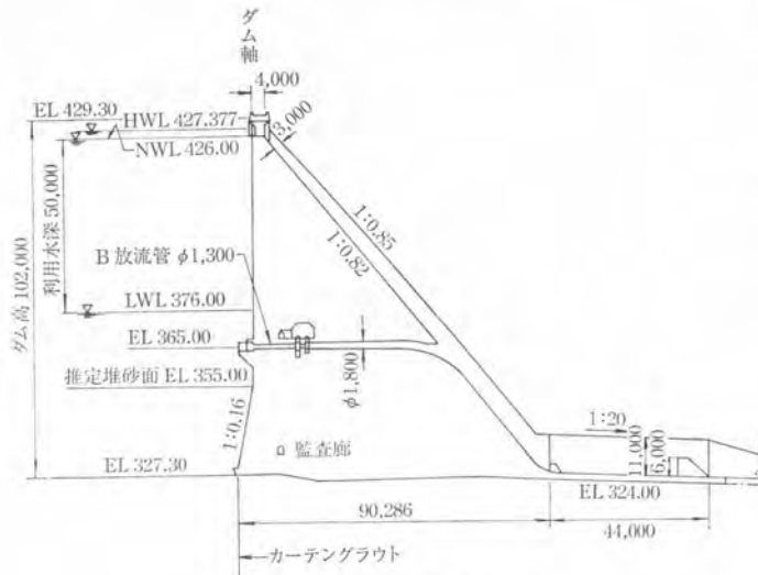
図-7 長谷ダム標準断面図
