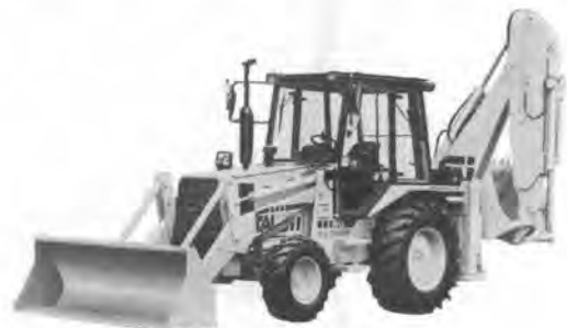
写真-3 小松ファイ 264 D バックホウローダ
