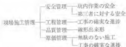
図-1 現場施工管理
