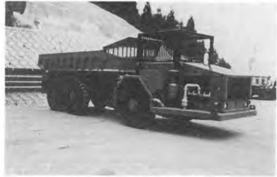
写真—5 坑内専用ダンプトラック (20 t)
