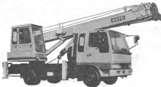
写真-6 加藤 NK-75 M-V 全油圧式トラッククレーン
