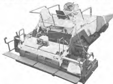
写真-12 新潟 NFB 6 C アスファルトフィニッシャー
