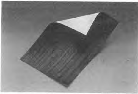
写真-1 炭素繊維補強材料 (UD テープ)
