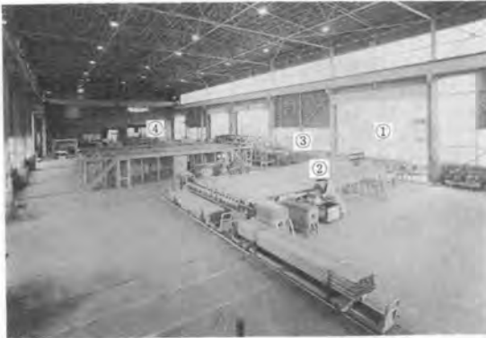
写真-1 単管パイプ自動再生整備装置全景 ①検収ライン、②加工ライン、③整備ライン、 ④完成ライン
