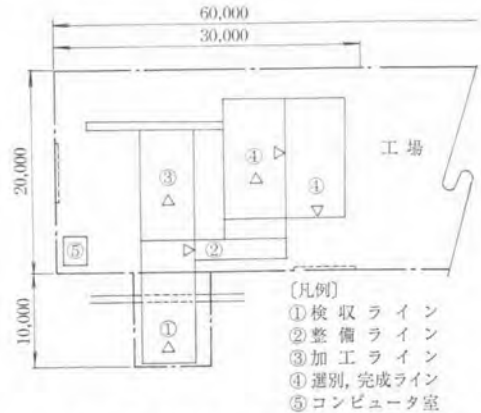
図-2 単管パイプの自動整備装置配置図
