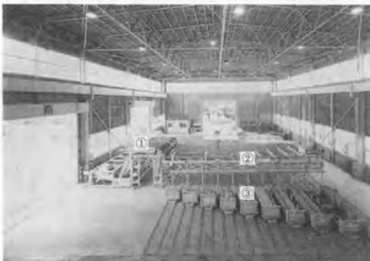
写真-3 整備ラインおよび完成ライン ①整備ライン、②完成ライン、③完成品台車
