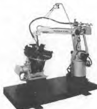
写真-8 小松 RAL 10-T 鉄骨溶接システム
