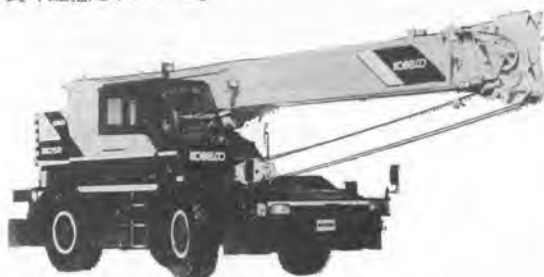
写真-6 コベルコ RK 250-II ラフテレーンクレーン
