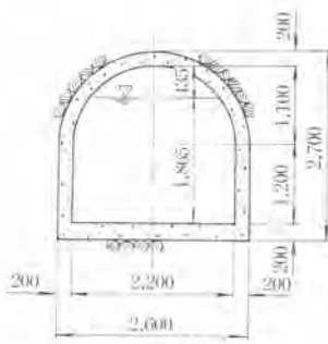
図-4 導水路定規図
