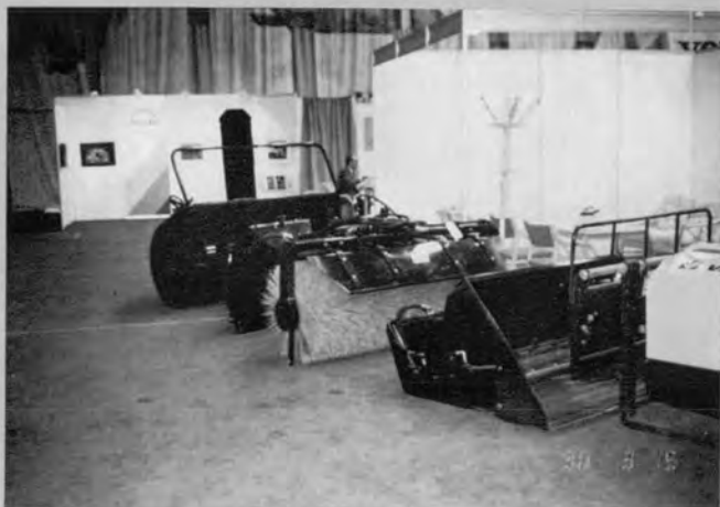
⇨ トラクタの各種アタッチメント (ロータリ, ブラウ, ブラシ, バケット)
