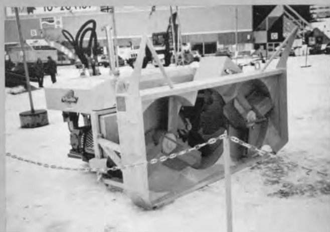
⇨ユニット型ロータリ除雪装置 Veraasen (ノルウェー) TWIN SPIN UPV 90-106S (左右の回転羽根で中央のプロアに雪を誘導する)
