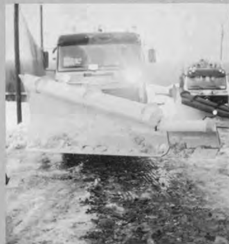
⇨除雪トラック (特殊ワンウエイブロー付) (左先端を折って回送時の幅を小さくする) ブロー Steinsland 車両 IVECO
