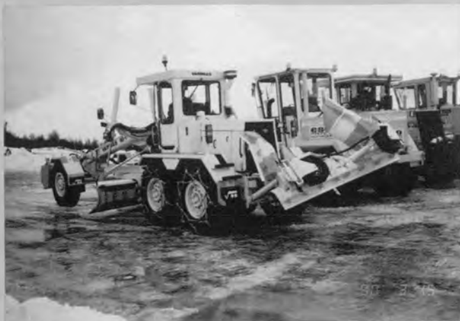
除雪グレーダ⇨ (前方一方向ブラウ, 後方路整ブラウ) Vammas (フィンランド) RG-17 アーティキュレートタイプ
