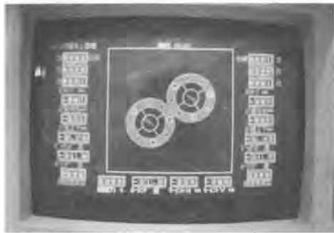
写真-4 シールド機姿勢計測とスパイラル状態の CRT 表示
