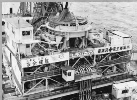
⇨ ポンプステーション (40m アジテータ, 貫入シリンダ型コンクリートポンプおよび中央監視室)
