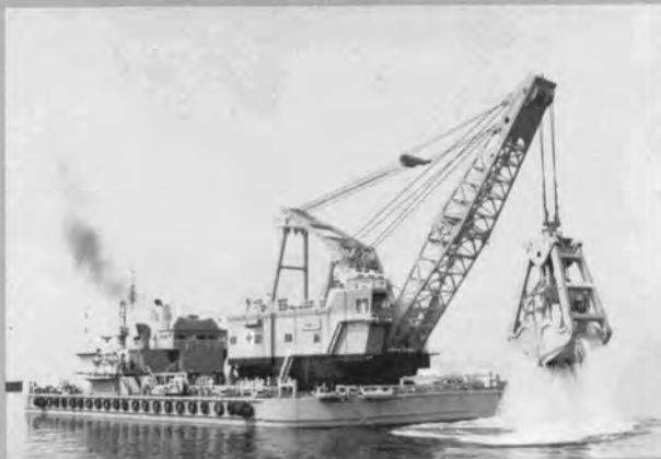
グラブ船バケット (ミディアム 32.5m 2 ・⇨ 150t, ウルトラヘビー 17.5m 2 ・200t, 平 バケット 18m 2 ・52t)
