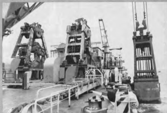
グラブ船バケット (ミディアム 32.5m 2 ・⇨ 150t, ウルトラヘビー 17.5m 2 ・200t, 平 バケット 18m 2 ・52t)
