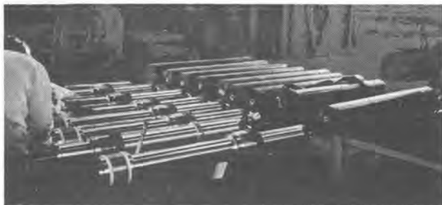
▲シールドジャッキの整備工場
