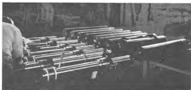
▲シールドジャッキの整備工場
