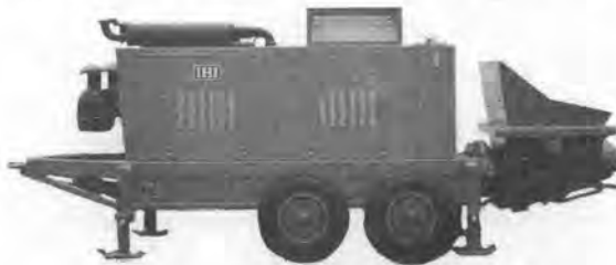
写真-12 石川島 IPG 60 ST-18 N (ハイバーストローク 180) コンクリートポンプ
