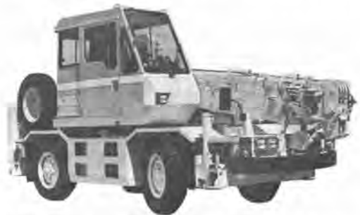
写真-3 コベルコ RK 70 M ミニラフテレーンクレーン
