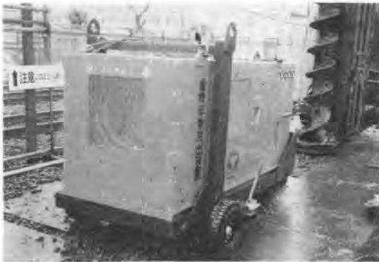
写真-49 重機非常脱出用パワーユニット
