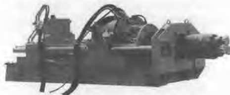
写真—21 SST 工法推進機 (500 型機)
