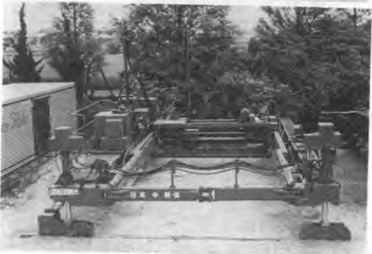
写真—33 コンクリート舗装機械(上から;スプレッダ, フィニッシャ, レベリングフィニッシャ)
