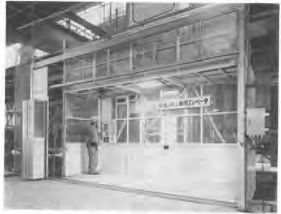
写真-5 高速自動工用エレベータ
