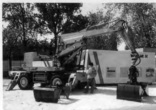
⇨東ドイツ製ホイール式パワーショベル (重量 11t, 68 PS)
