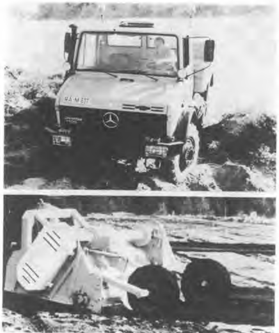
写真-8 ベンツウニモグ STZ1900 ストーンクラッシャー
