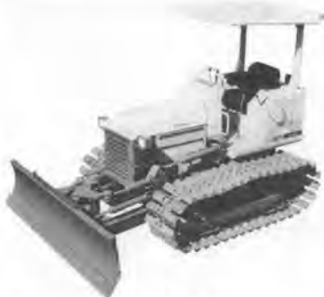
写真-2 日立 DX 40 M 湿地ブルドーザ
