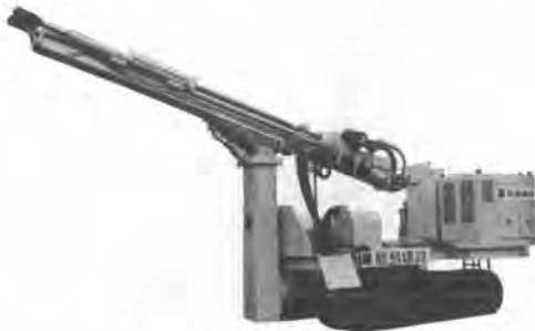
写真-13 AB フォアパイル機
