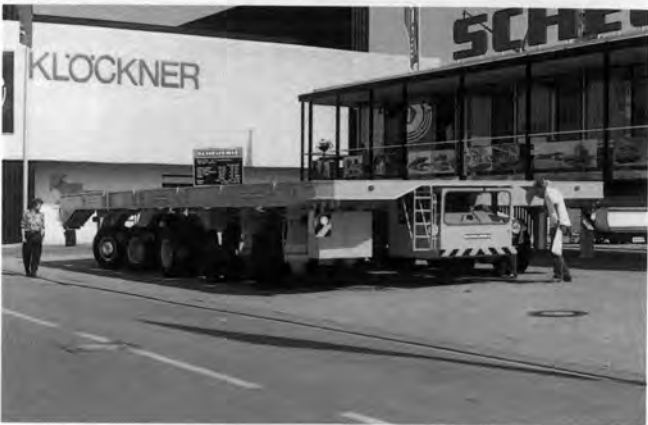
⇨重量物運搬車 (SCHEUERLE 社)
