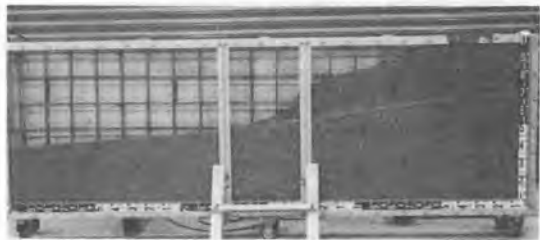
写真-2 壁モデル試験体による流動特性試験
