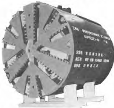
写真-1 泥土圧シールド機 (春日町第二工区)
