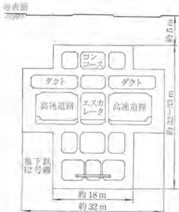
図-7 環6区間12号線駅部標準断面図
