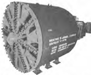
写真-2 泥土圧シールド機 (豊島園第二工区)
