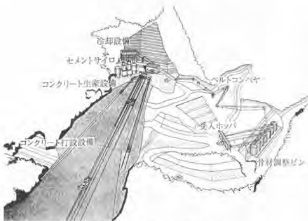
図-7 骨材貯蔵輸送設備
