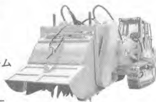
963路盤再生用スタビライザー 1500mm×400mm
