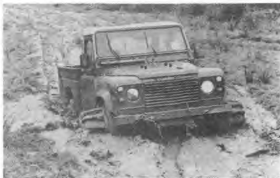
写真-2 ボグコグを付けたランドローバは悪コンディションもらくにこなす
