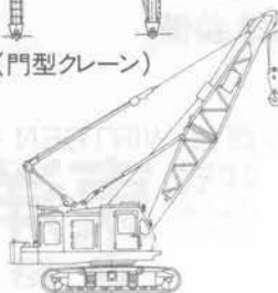
(クローラークレーン)
