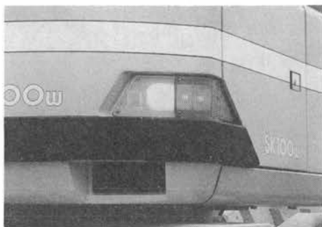
写真—6 旋回警告灯，セーフティバンパ（神鋼 SK 100 W）
