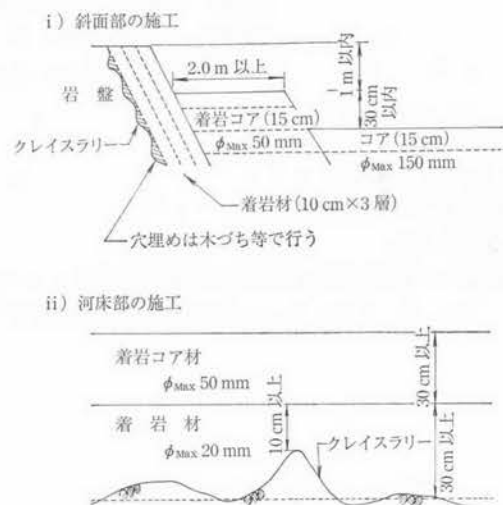
図-9 着岩部の施工
