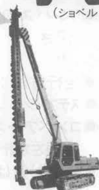
(くい抗機ダイワ アドミックDAK-150)
