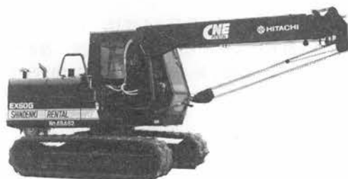
写真-3 2.9 t ぶりクレーン付ショベル (日立 EX 60 G)
