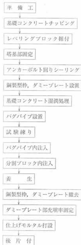
図-8 グラウト工施工手順
