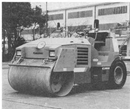
写真—2 視界等安全性を配慮し開発されたローラの例
