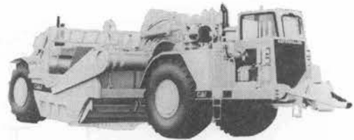
写真-3 CAT 637 E モータスクレーバ (タンデム)
