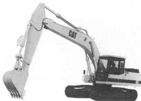
写真-4 CAT E 200 B 「PRO FORCE」油圧ショベル
