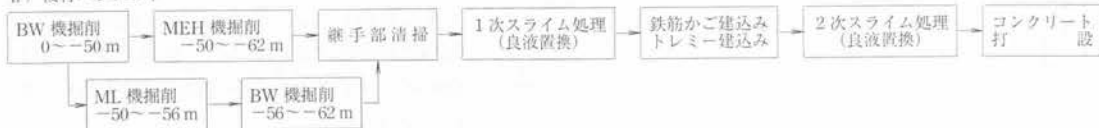
図-8 BW 工法施工フロー
