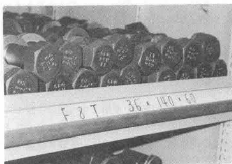
写真-4 ボルトの保管状態
