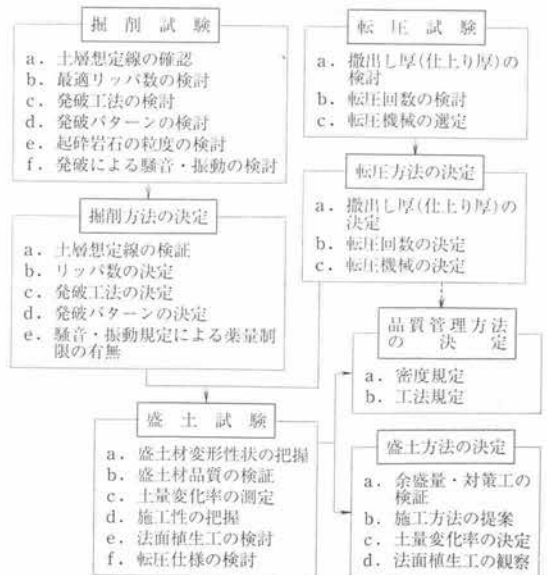
図-5 試験工事全体フロー
