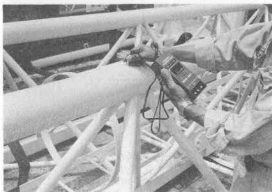
写真-3 超音波による肉厚測定
