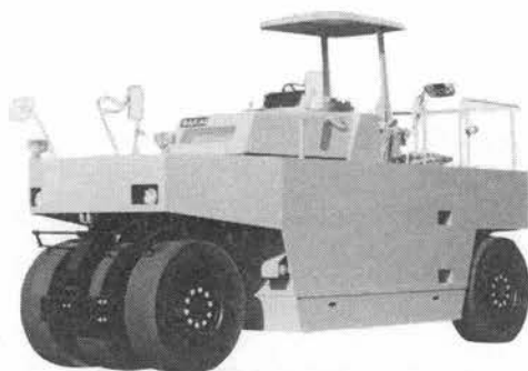
写真—3 トルコン・パワーシフト駆動タイヤローラの例
