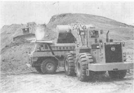
写真-3 積込、運搬を行う 10m³ 級ホイールローダと 46 t 級ダンプトラック
