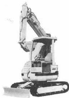
写真-2 神鋼コベルコ SK 30 UR 車幅内旋回ショベル
