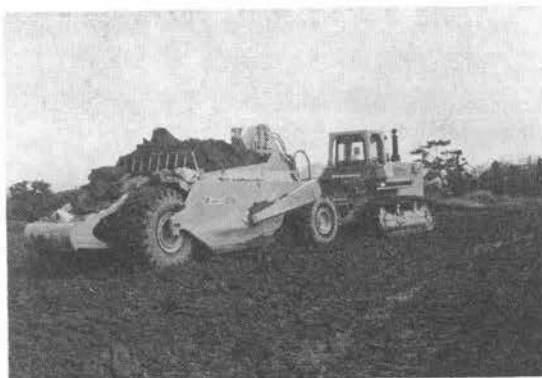
写真-1 コクド 23 SB 標準スクレーパー
