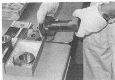
写真-5 リングゲージによるネジ山のチェック
