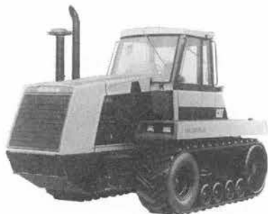
写真-1 CAT チャレンジャー 65 高速ゴム履帯式トラクタ
