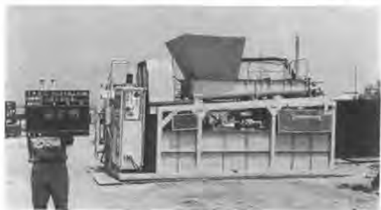
写真-1 解泥プラント
