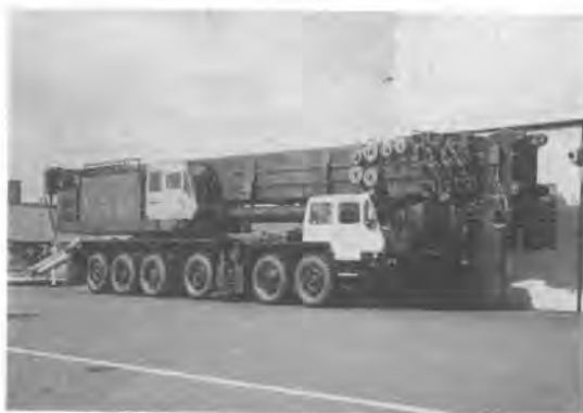
写真-5 タダノ TG-3600 M 超大型油圧式 トラッククレーン
