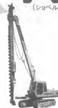
(くい抗機ダイワ アトミックDAK-150)
