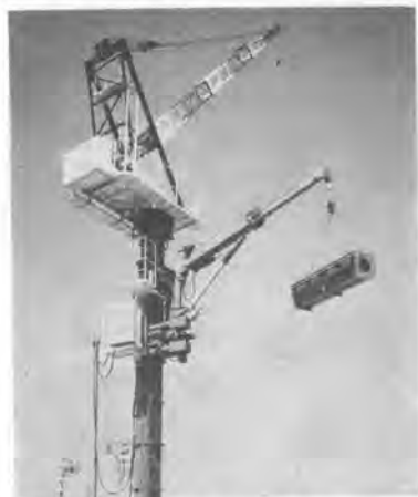
写真-6 三井三池 MJC 0105-S 昇降クレーン (および MJC 0120-OP ジブクレーン)
