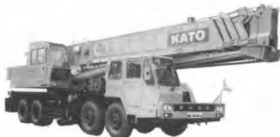
写真-4 加藤製作所 NK-450 B-V 専用キャリア 架装油圧式トラッククレーン
