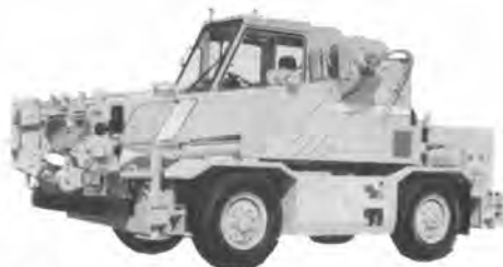
写真-6 神戸製鋼所 RK 70 M ラフテレーン クレーン
