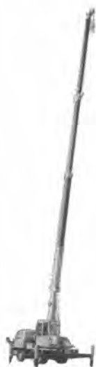
写真-3 愛知車輛 F-304 汎用シャシ架装油圧式 トラッククレーン
