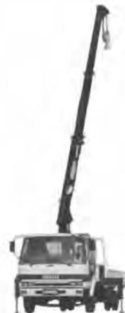
写真—2 古河機械金属 UR-333 トラック搭載型クレーン
