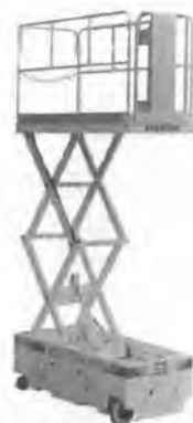
写真-7 日本車輛 COS-270 AM 高所作業車 「昇太郎」
