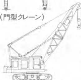
(クローラークレーン)
