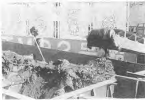
写真-5 脱水ケーキ積込状況
