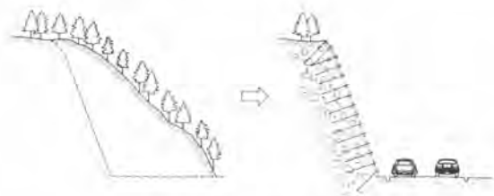
図一 ロックボルト工法
