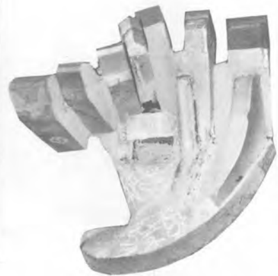
ビットの修理加工
