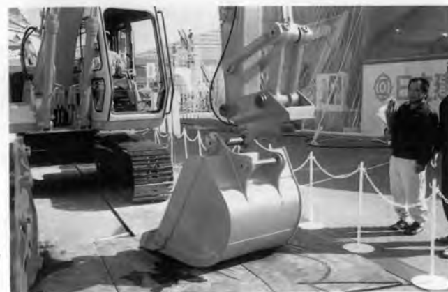
ショベルアタッチメント脱着装置 — ロックヒッチ
