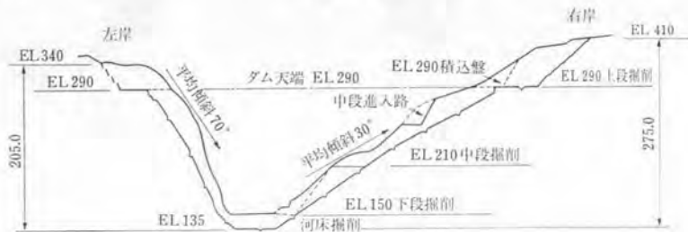
図-1 堤体掘削断面図
