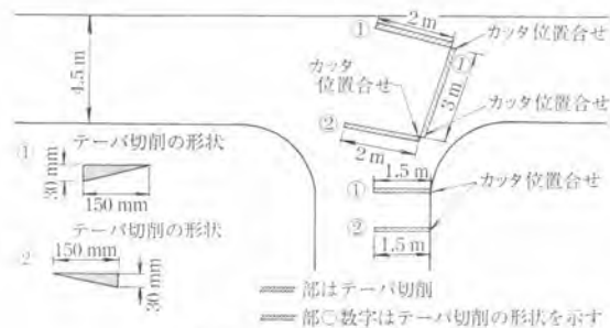
図-11 テーバ切削作業
