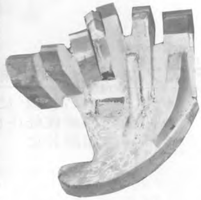
ビットの修理加工
