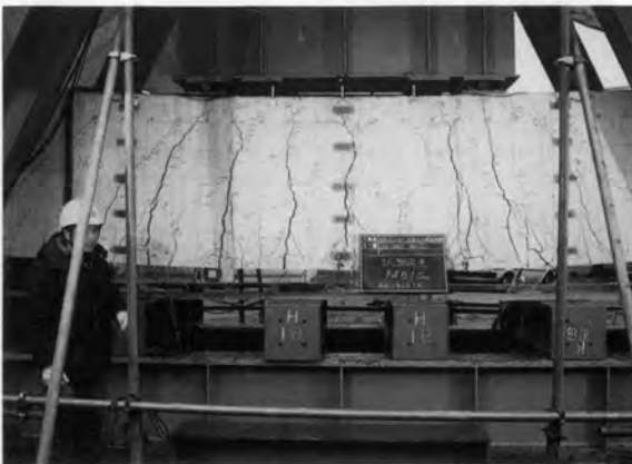
合成構造方式沈埋函の構造実験，はり部材載荷実験（コンクリート圧壊時）
