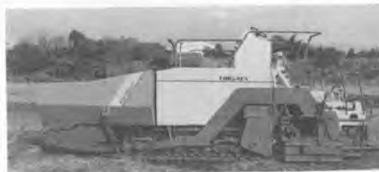
写真-5 アスファルトフィニッシャ (クローラ式) (新潟鉄工 NFB6C-TV)
