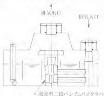
図-1 SDMW 外形図 小型フォークリフト用基本構造図
