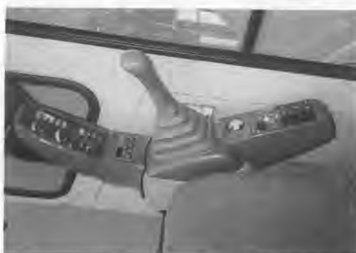
写真-1 バックホウの操作レバーとメータ(日立建機)
