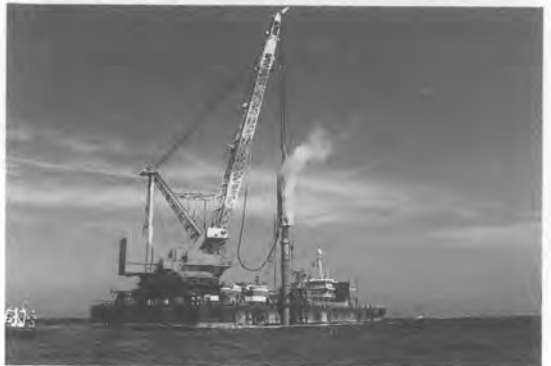
写真—7 大型杭打機（スチームハンマー）ハンマー重量150t、ラム重50t、エネルギー75t・m
