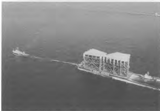
写真—5 川崎人工島ジャケット輸送台船（6,600t）
