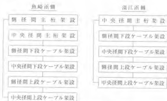
図-14 主桁とケーブルの架設サイクル
