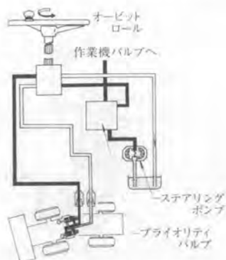
図-6 オービットロール式ステアリング
