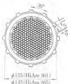
図-7 ケーブルの制振対策
