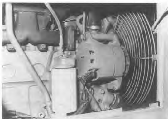
写真-3 ファンガードの設置
