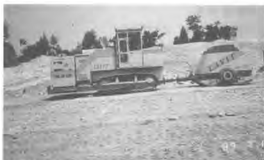
写真1 けん引式 MVT 施工機
