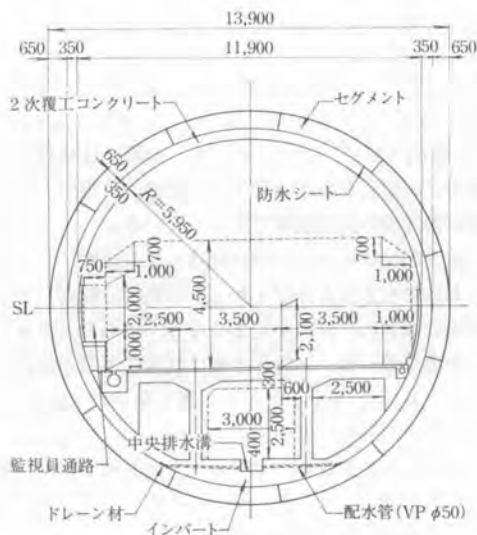
図9 シールドトンネル断面図
