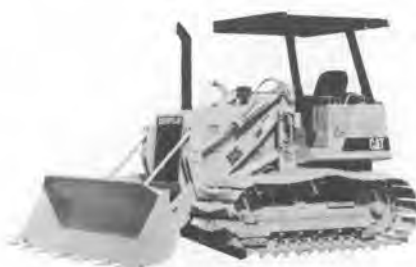
写真-6 CAT 931 C シリーズII トラクタタイプローダ
