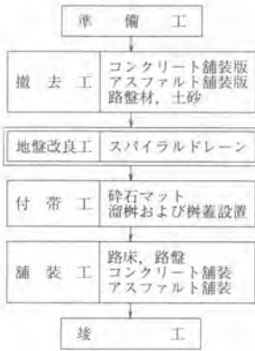
図-8 施工フロー
