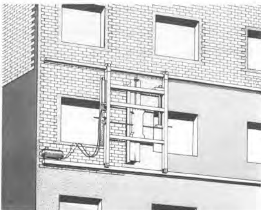
図-1 タイル張りロボット概念図
