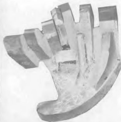
ビットの修理加工
