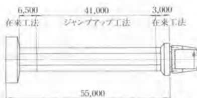
図-2 ジャンプアップ工法と在来工法の併用
