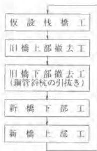
図-3 施工フロー
