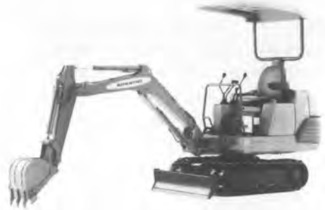
写真-2 小松 PC 05-7 ミニパワーショベル
