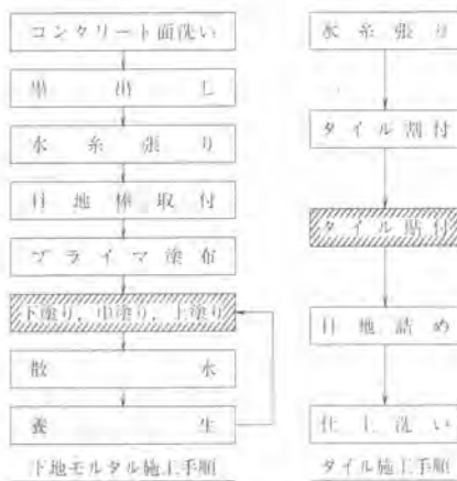
図-2 外装タイル施工手順
