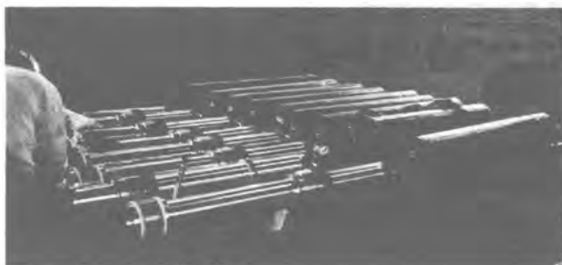
▲シールドジャッキの整備工場
