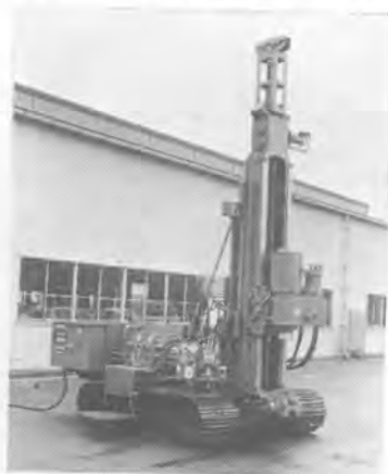
YBM-SS-60地盤改良機
