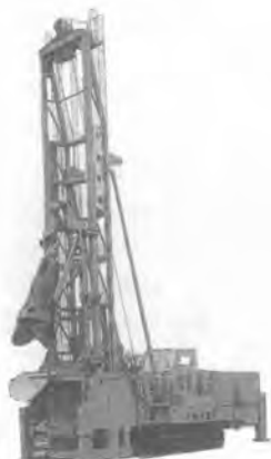
写真-10 三菱 MAC 2000 ボーリングマシン
