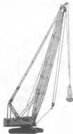
写真—6 日立 KH 250 HD クローラクレーン
