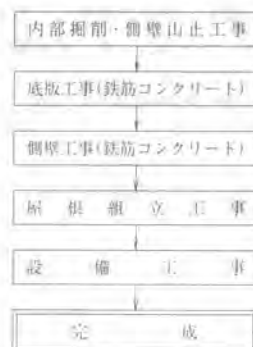
図-1 地下タンクの施工手順
