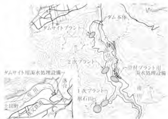
図-10 浦山ダム施工機械設備配置図
