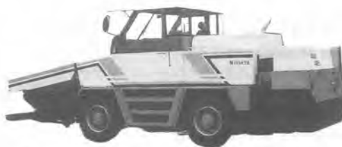
写真—6 新潟セントリー 21 アスファルトフィニッシャー
