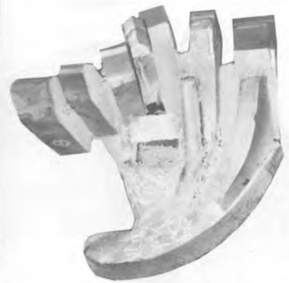
ビットの修理加工
