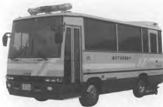
写真-6 路面下空洞探査車（関東地建導入車）
