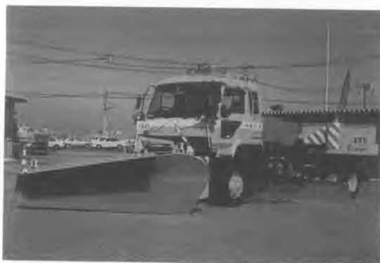
写真-7 除雪トラック（10t級、自動変速、自動路面修正装置付き）
