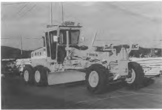
写真-2 除雪グレーダ (3.7m級総輪駆動式)
