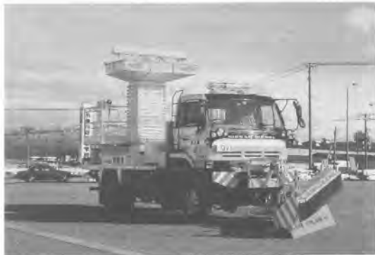
写真一八 除雪トラック（7t級、ツララ処理装置付き）
