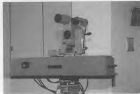
写真-24 トンネル断面自動マーキングシステム
