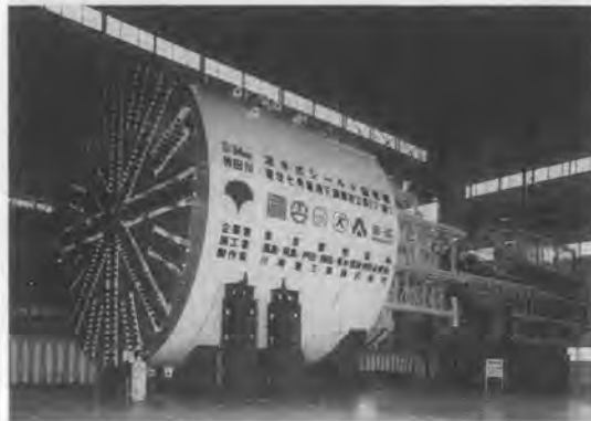
写真-2 シールド機 外径φ13.94 m, 機長 l=11.825 m, 後続操縦約30 m
