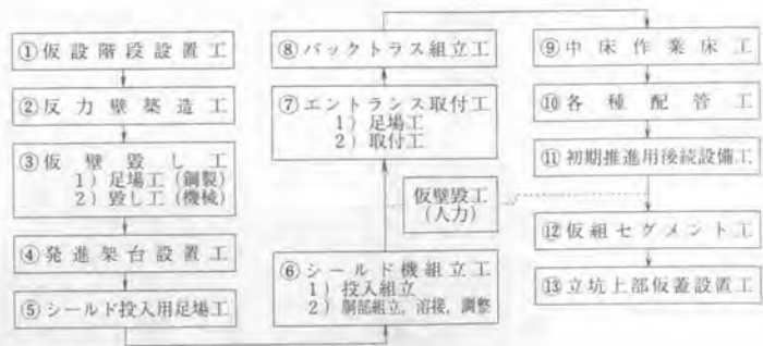
図-7 発進準備工の各作業
