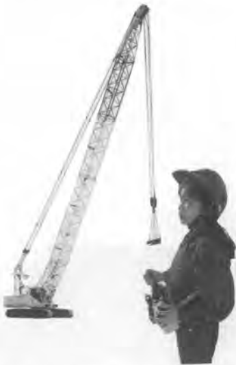
写真-4 無線操縦式クローラクレーン
