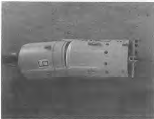
写真-25 全断面機内地盤改良型泥土加圧シールド機
