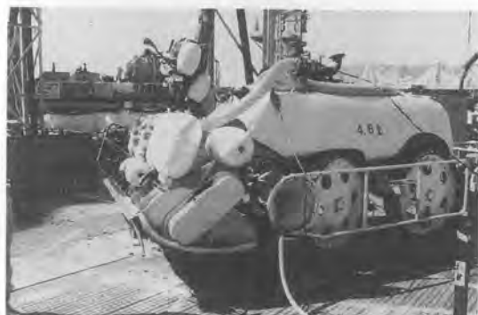
写真-5 水中打継目処理ロボット
