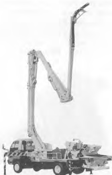
写真-6 極東開発 PH 65-18 ブーム付コンクリートポンプ車
