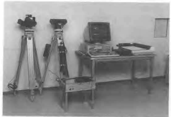
写真-23 トンネル断面計測システム
