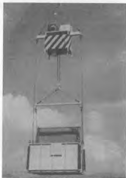
写真-35 RCD工法コンクリートバケット
