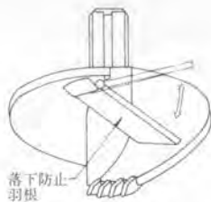
図-3 土の落下防止羽根 (砂質用オーガヘッド)
