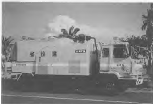
写真-3 桜島降灰処理用に特別に開発された路面清掃車
