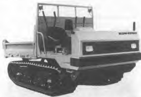
写真-6 KOMATSU SE 23-1 ゴムクローラキャリヤ
