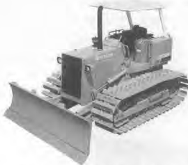
写真1 日立 DX 75 M 湿地ブルドーザ
