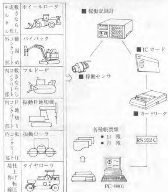
図-27 重機稼働管理システム構成図
