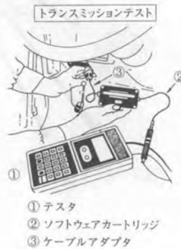
写真-1 診断機のセット内容とテスト作業例 (トランスミッションテスト)
