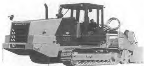
写真-9 KOMATSU CS 210-1 クローラ式スタビライザ
