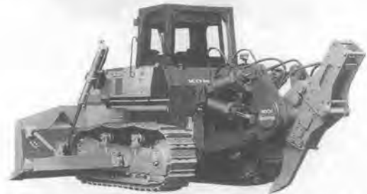
写真2 KOMATSU DR 450-1 自動衝撃リッパ装着車
