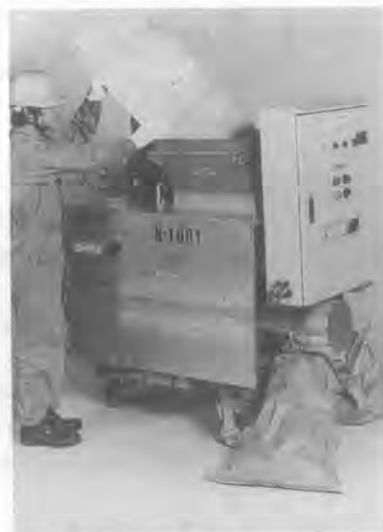
写真-54 ゴミ破碎装置・オール・バック
