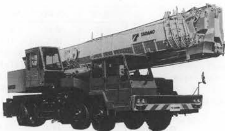
写真-6 タダノ TG-500M トラッククレーン
