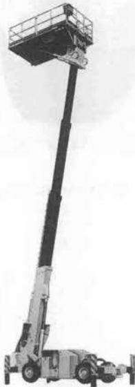
写真-7 タダノ AP-182 ZGズームリフト
