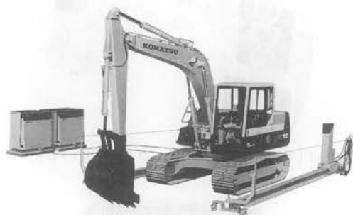
写真—9 KOMATSU YC 200-1 建機足回り洗車ロボット
