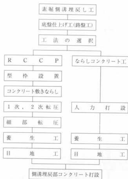
図-6 底盤作業手順
