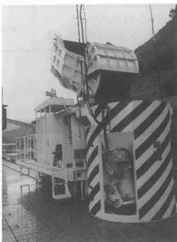
写真-1 コンクリート自動運搬システム
