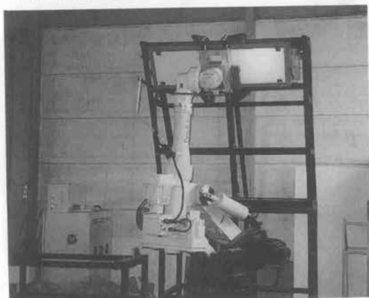
写真-2 灯具交換実験装置
