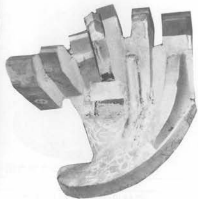
ビットの修理加工
