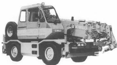
写真-5 神鋼 RK 70 M シティコンシャスクレーン
