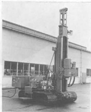
YBM-SS-60地盤改良機
