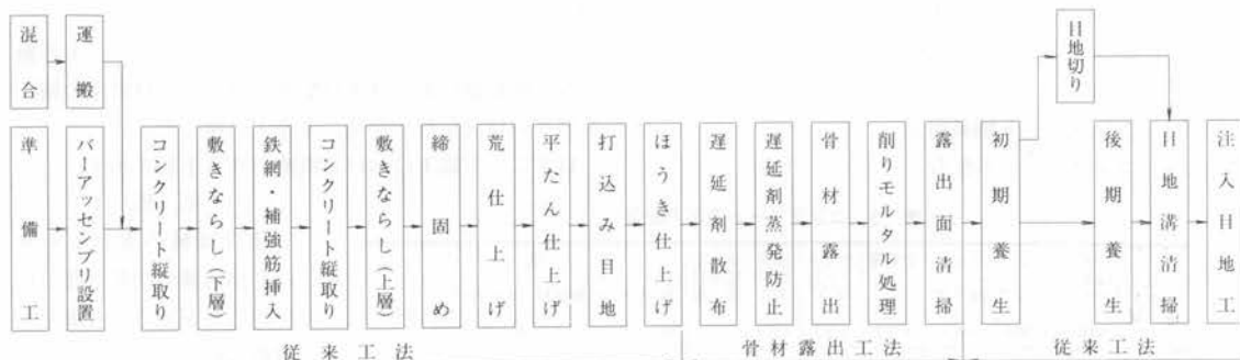
図—6 舗設作業のフローシート
