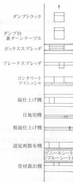
図—5 舗設機械の設置
