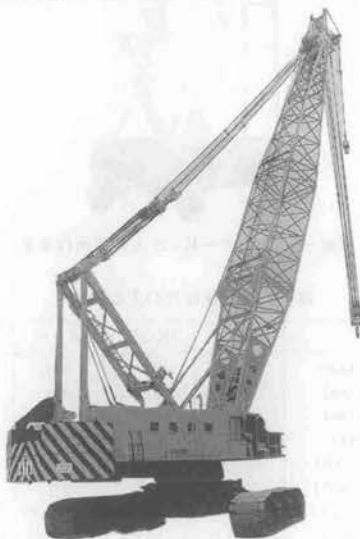
写真-5 石川島 DCH 15030 ハイラインブルクローラクレーン
