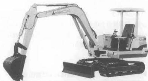
写真-3 三菱 MM35 スタンバイ油圧ショベル
