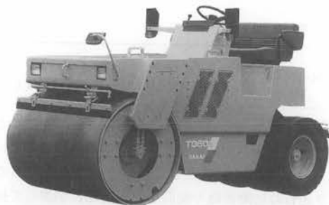
写真-7 酒井 TG500 コンバインド型振動ローラ
