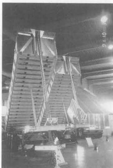
写真-7 多段式油圧シリンダ使用例
