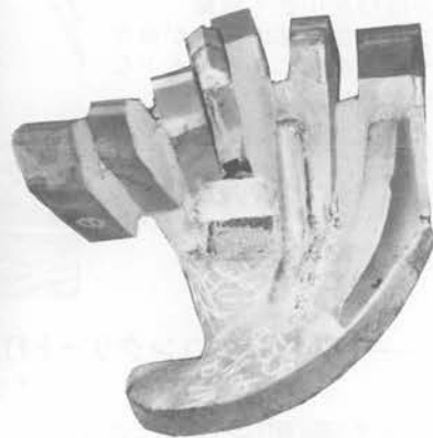
ビットの修理加工
