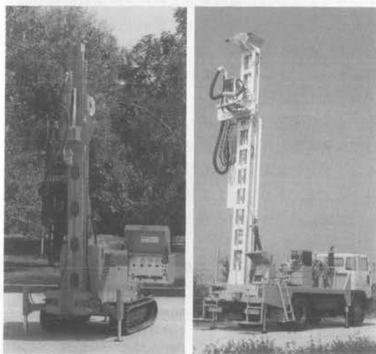
写真-8 Fraste社のコンピュータ制御によるせん孔機械の一例
