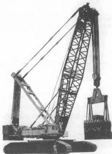
写真-5 神鋼コベルコ 7800 超大型クローラクレーン
