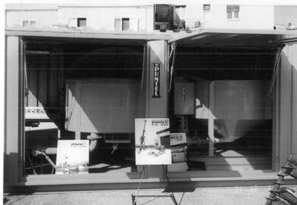
コンピュータ導入の現場注入攪拌システムコンボ (PUNTEL社)
