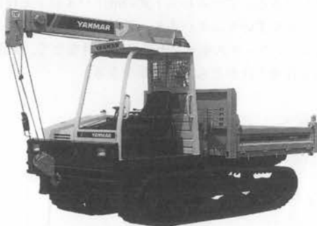
写真4 ヤンマー C40R-2K クレーンキャリヤ
