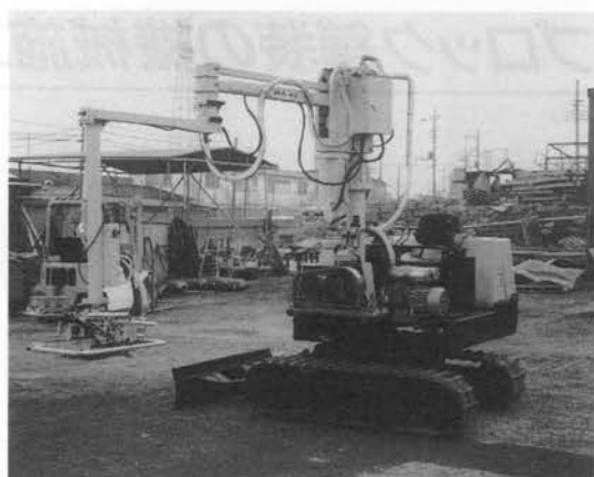
写真-2 真空吸着式ブロック組替敷設機械
