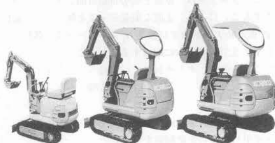
写真—2 神鋼 SK 005, SK 013, SK 015 ボータレスショベル
