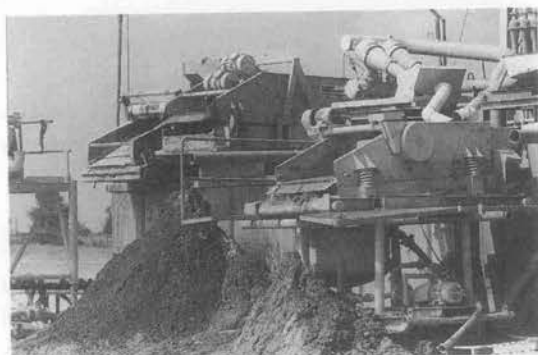
写真-9 スーパースクリーンからの排出土砂(シルト)
