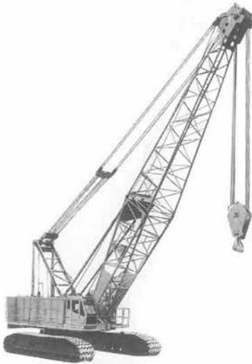
写真—5 神鋼コベルコ BM 1200 全油圧式ヘビーデューティローラークレーン
