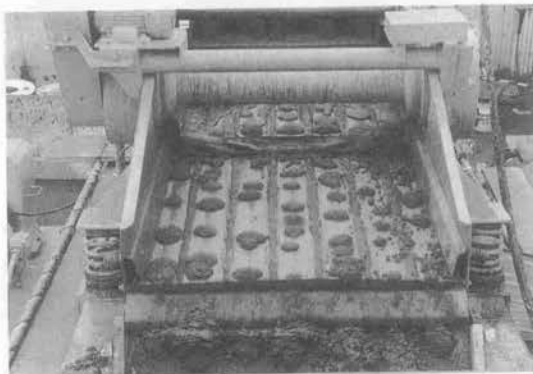
写真-10 スーパースクリーンからの排出土砂(砂)
