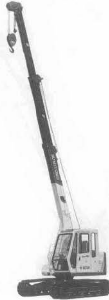
写真-4 住友SC50 アストロボーイ・テレスコクレーン
