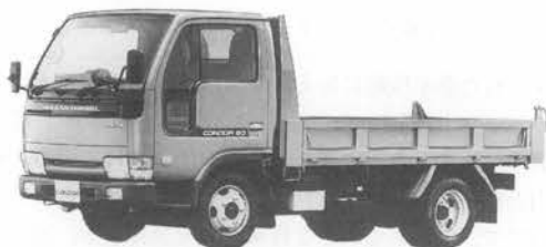
写真—4 日産ディーゼルコンドル 20, U-DW 2S 41 ダンプトラック
