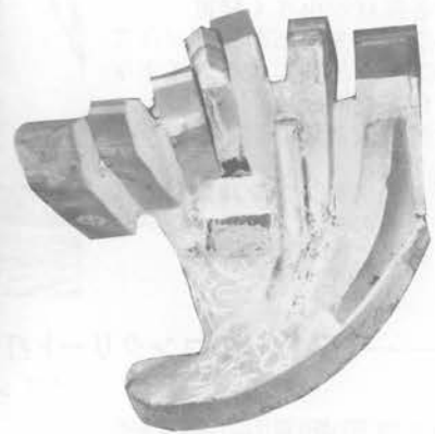
ビットの修理加工
