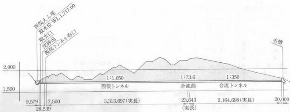
図-5 二軒小屋(発)水路縦断面図
