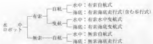
図-10 水中ロボットの分類
