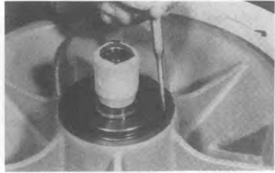
2 ストップリングの穴に専用のプライヤの先端を差込み、内側に変形させながらストップリングを抜取る。
