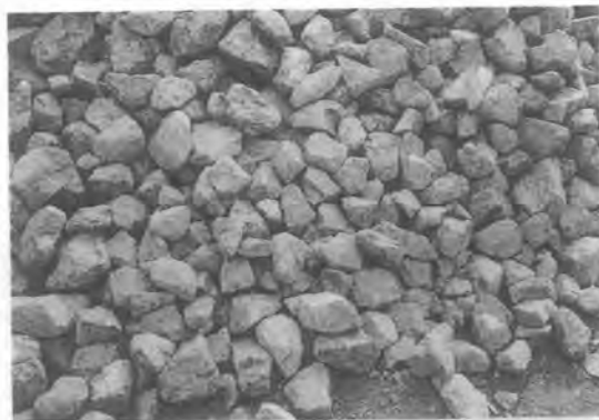
写真-3 粗骨材ストックパイルの製品 (150~80)
