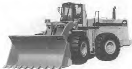
写真一六 KOMATSU アバンセ WA 600-1 ヘビーデューティ仕様ホイールローダ
