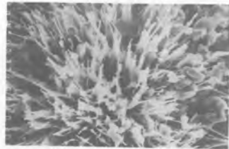
コンクリート内部深くに生成された 結晶の電子顕微鏡写真
