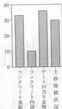
図-6 点検が必要と考えられている箇所（堰、水門）
