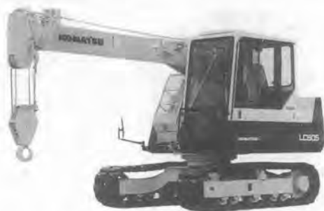
写真-8 KOMATSU LC 605-1 クローラクレーン
