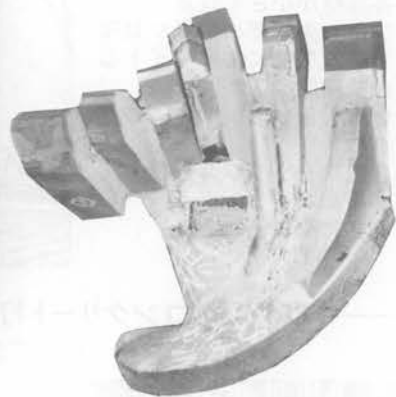
ビットの修理加工
