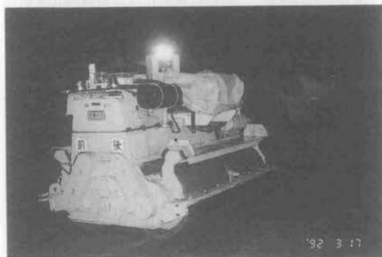
写真-4 位置検出装置（車両側）を搭載した自動運行中の振動ローラ
