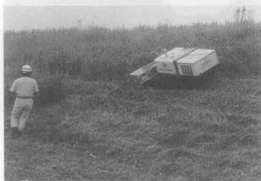
写真-3 小型遠隔操縦草刈機
