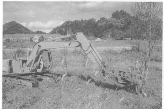
写真—6 立木処理装置
