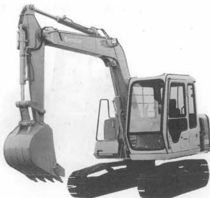
写真一八 日立建機ニュー EX 60 油圧ショベル
