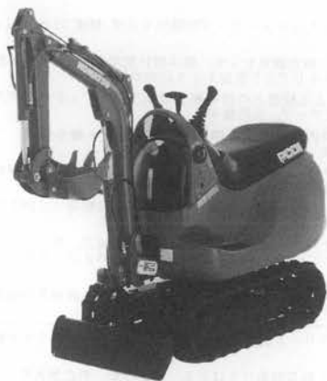
写真-2 コマツ PC01 マイクロショベル
