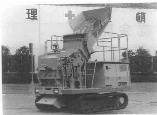
写真-14 コマツ BR60 解体ガラリサイクル車
