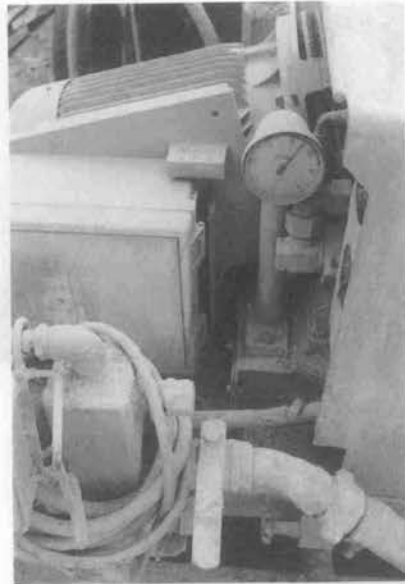
写真-4 パルスセンサの取付位置 (アリバー 280)
