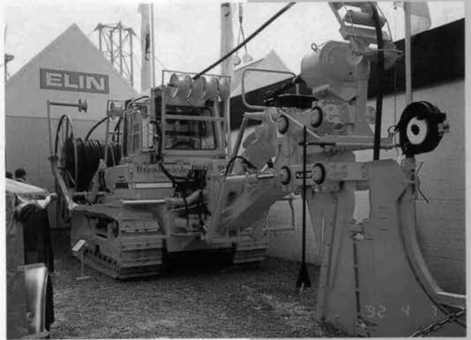
♣ ケーブル敷設車
