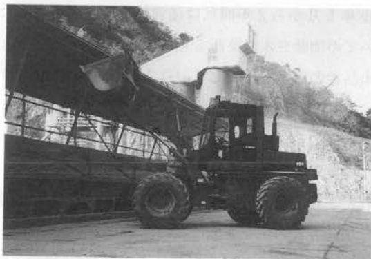
写真—1 無人ホイールローダ自動運転状況
