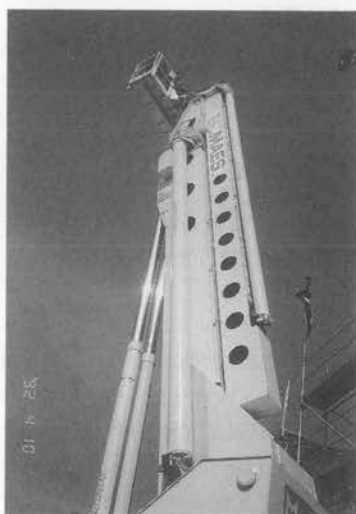
写真—4 65 m 高所作業車
