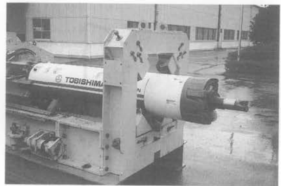
写真-30 ガイドボーリング工法
