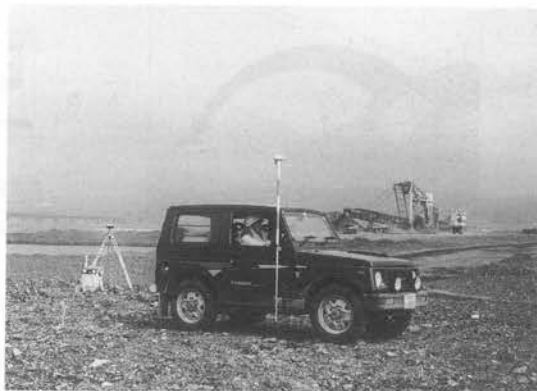
写真-2 車両によるGPS高速ダイナミック測位(関西国際空港)
