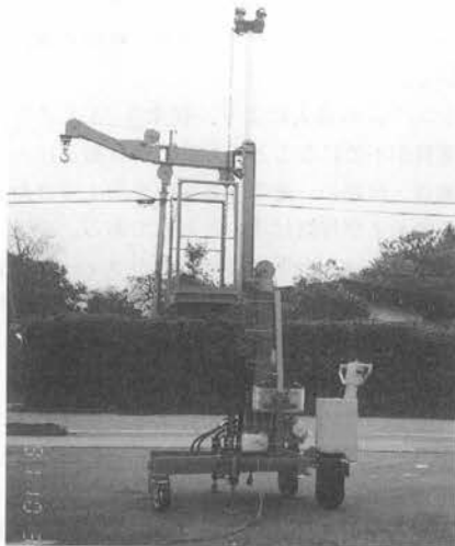
写真—49 ALC版取付装置「ボードクレーン」
