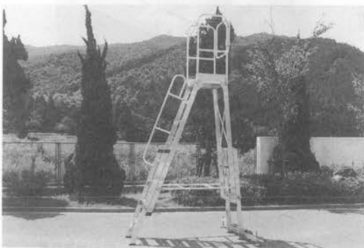
写真—51 高所作業用足場
