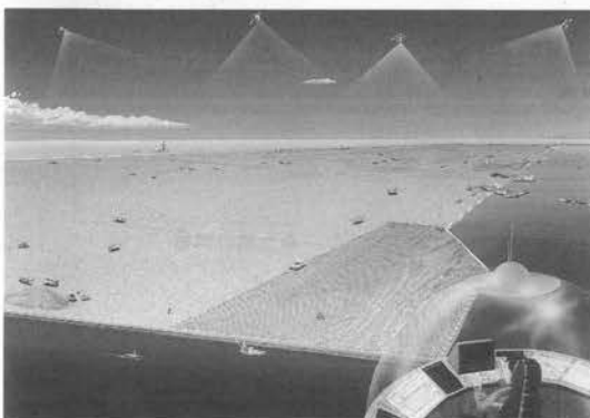
図-6 車両による広域3次元地形計測概念図(関西国際空港)
