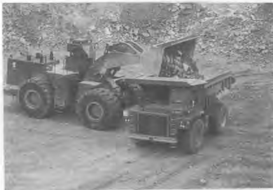
写真-5 積込・運搬を行う10m 3 級トラクタショベルと77t級ダンプトラック
