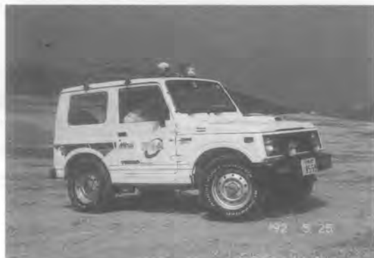
写真-2 自動車による走行連続地形測量
