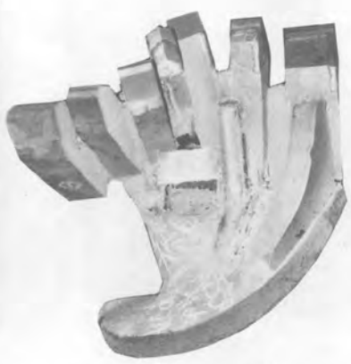
ビットの修理加工
