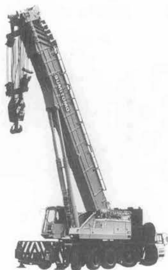
写真—6 住友SA 1700 オールテレーンクレーン
