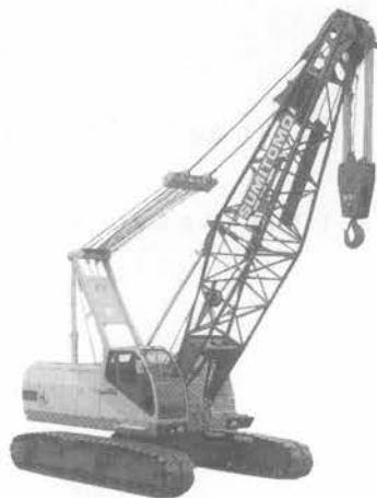
写真-5 住友 PAX シリーズクローラークレーン
