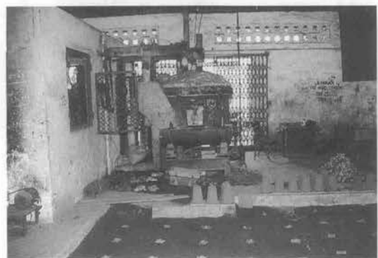
写真-4 水利省傘下の HYCO No.4 の工場。部品は何でも自分で造ってしまう。写真は電気炉と鋳造の砂型。
