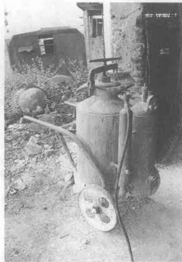
写真-3 アセチレンガス発生装置。カーバイドをタンク内の水に漬けガスをゴムホースでトーチへ取る。どこの工場でも同じだった。
