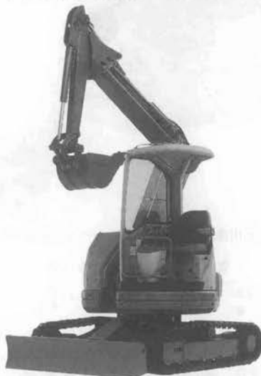
写真-2 KOMASTU PC 38 UU -2 超小旋回式パワーショベル
