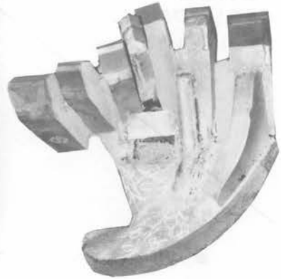
ビットの修理加工
