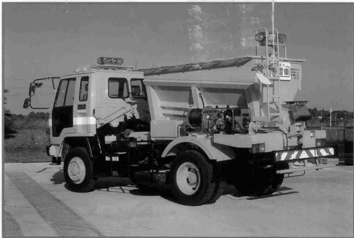
凍結防止剤散布車 ESD 25-2 型 4 輪駆動仕様車 東洋運搬機株式会社
