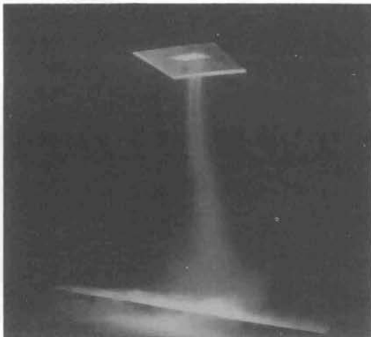
写真-4 旋回流換気システム
