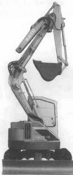
写真-2 加藤 HD-50 UR 超小旋回式ミニショベル
