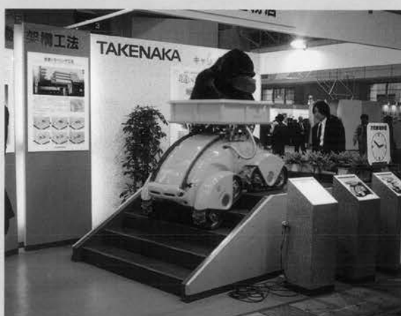
階段を登る4クローラキャリアロボット
