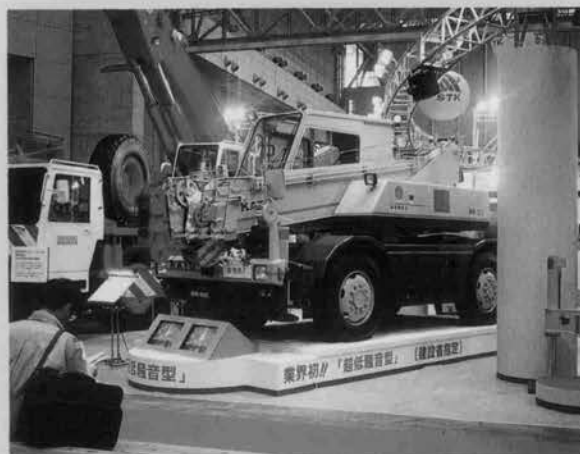
超低騒音型指定のラフター
