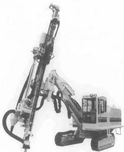
写真—8 古河 HCR 15-ED 油圧クローラドリル
