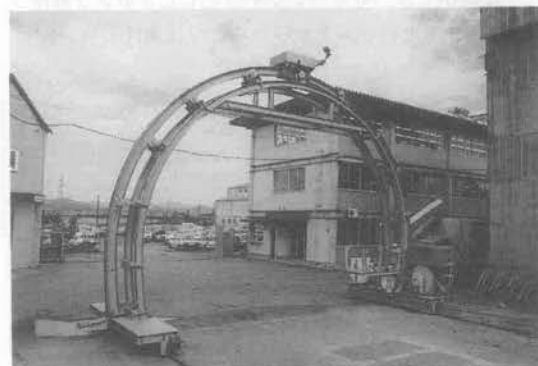
写真-2 防水膜吹付機
