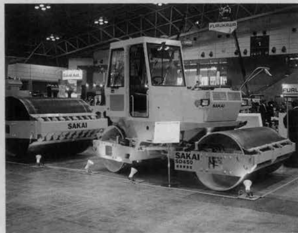
垂直振動型振動ローラ
