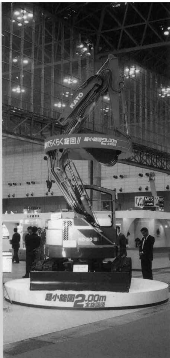
各社が力を注ぐ車幅内旋回ショベル
