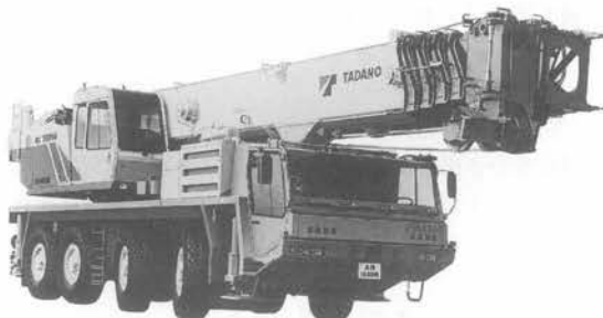
写真-1 オールテレーンクレーン AR-1000 M
