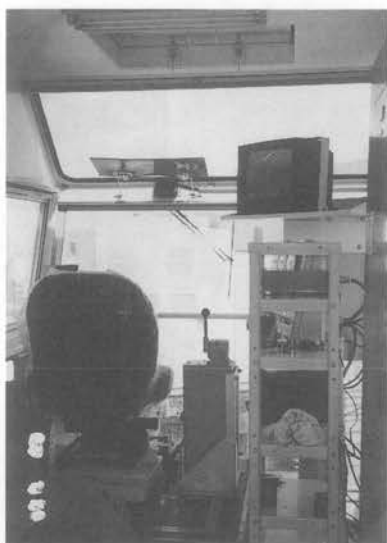
写真—6 ダム建設用タワークレーンの運転室内部
