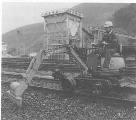
写真4 KOMATSU PC 02 T-1 W バラストスコップ
