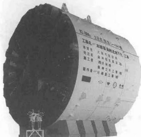
写真-11 川崎 10.8 mφ土圧式(気泡)シールド機
