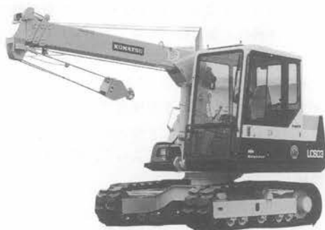
写真-8 KOMATSU LC 603 クローラクレーン
