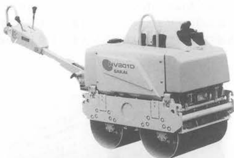
写真-12 酒井 HV 201 D 振動ローラ
