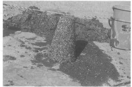
写真-3 ESP ビーズ混合状況 (ESP ビーズ添加率 45%, セメント系改良材添加量 50 kg/m 3 )
