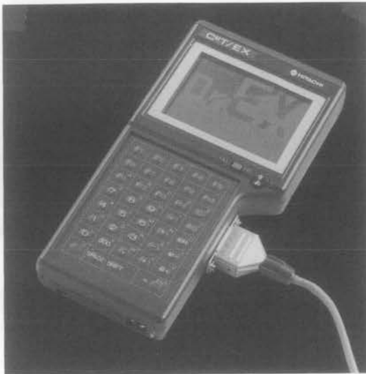
写真-3 EX-2シリーズ用動作状況確認故障診断装置 Dr. EX
