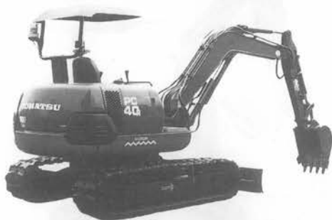
写真3 KOMATSU PC 40 R-7 アバンセラジコン車
