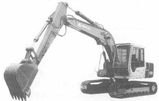
写真—7 日立 EX 120 K 解体作業用油圧ショベル
