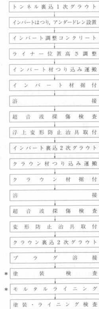
図-8 施工フロー
