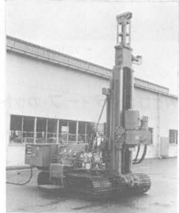
YBM-SS-60地盤改良機
