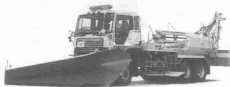
写真-14 日野スーパードルフィンプロフィア U-FU 3 FPBA 改除雪車
