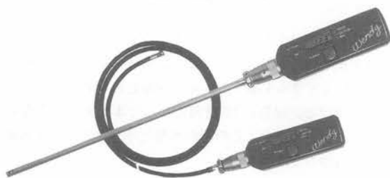
写真-6 デジタル表示式オイルチェッカー
