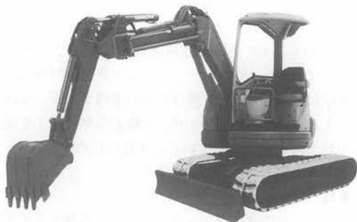
写真-2 KOMATSU アバンセ PC 38 UU-2 白色ゴムシュー仕様機
