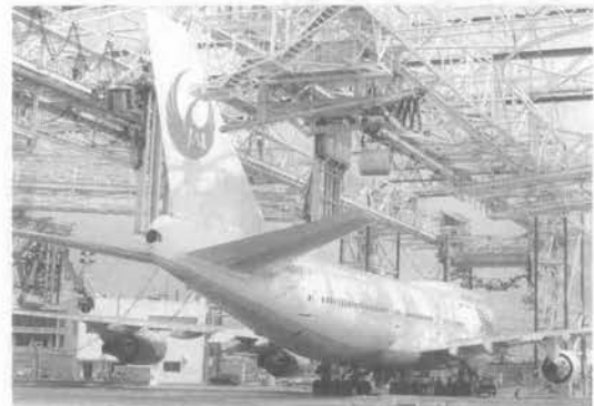
写真-8 航空機自動洗浄装置
