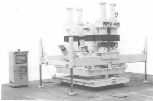
写真一 低空間杭打機全景
