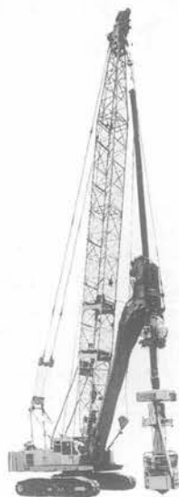
写真-7 日工 HE 6010 B 拡底杭施工用アースドリル
