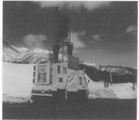
写真—5 のり面点検車
