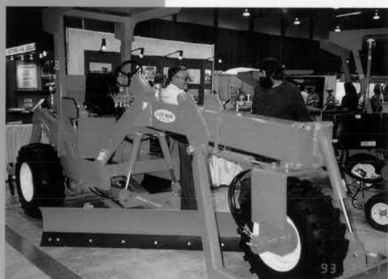
⇨ 三輪グレーダ(LAY・MOR)
