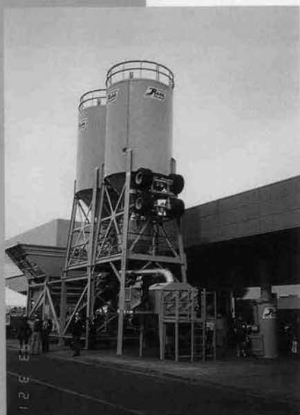
◀ コンクリートバッチャプラント (ROSS)
