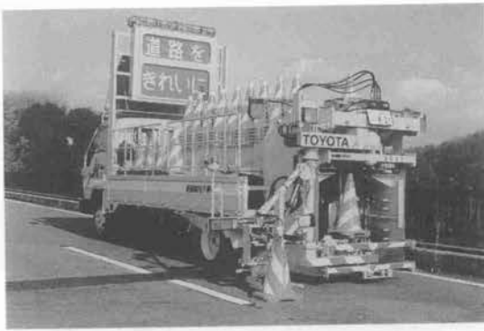
写真-2 交通規制用コーンの自動設置・撤去ロボット
