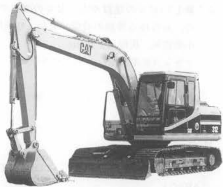
写真2 CAT 312 REGA 油圧ショベル(ブレード仕様機)
