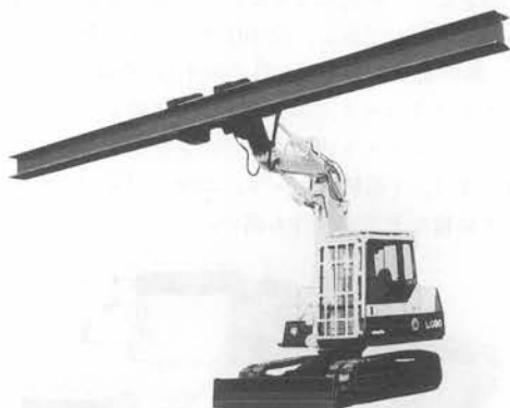
写真6 KOMATSU LG 90「Rexy (リキシー)」山留め用鋼材ハンドリング機
