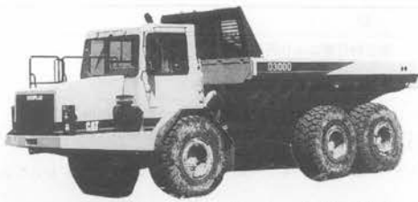
写真—9 CAT D300 D アーティキュレートダンプトラック
