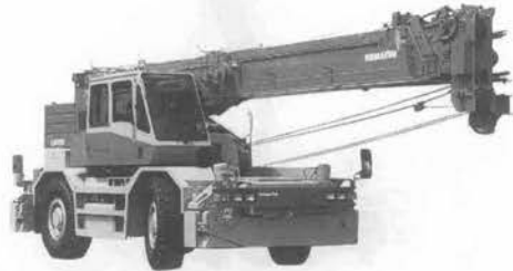
写真-4 KOMATSU LW 250-3ラフテレーンクレーン
