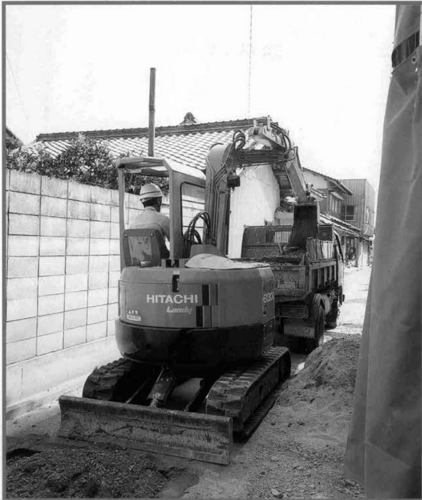
超小旋回型ミニショベル Landy KID EX30UR 日立建機株式会社
