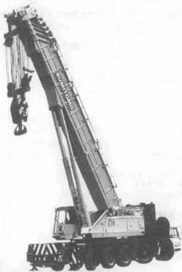
写真一 住友 SA1700 オールテレーンクレーン
