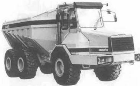
写真-3 KOMATSU HA 270-3アーティキュレートダンプトラック
