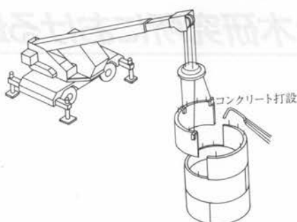
図-2 プレキャスト型枠による施工
