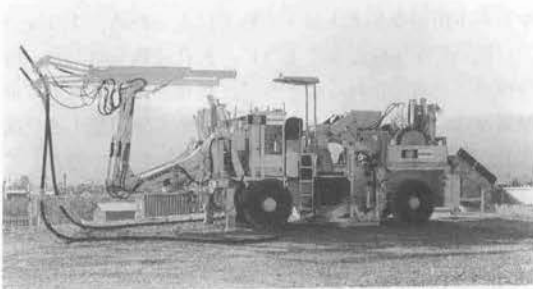
写真—2 新型吹付システム (吹付機は両タイヤの間にある。後部はホッパ)
