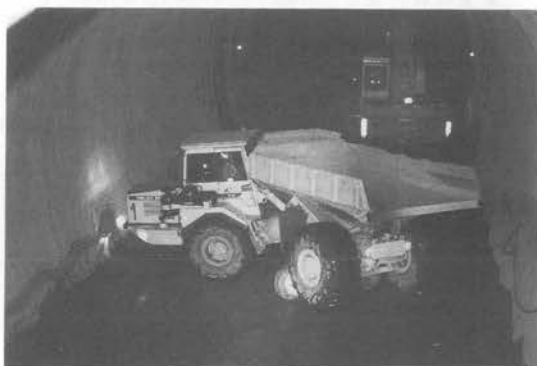
写真-1 坑内で方向転換中のボルボ BM A25B
