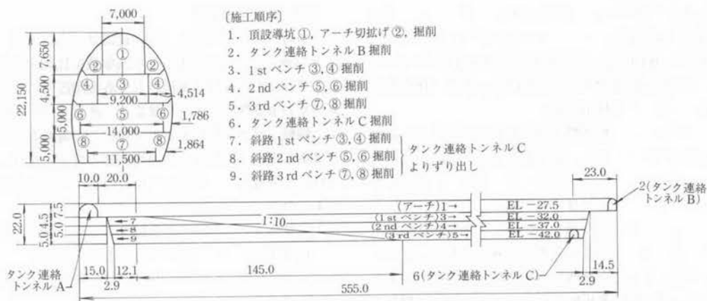
図—6 岩盤タンク加背割, 施工順序
