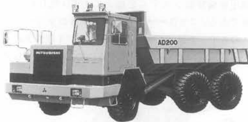
写真-6 三菱 AD 200 アーティキュレートダンプトラック (トンネル仕様車)
