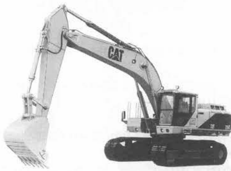
写真-1 CAT「REGA」350油圧ショベル
