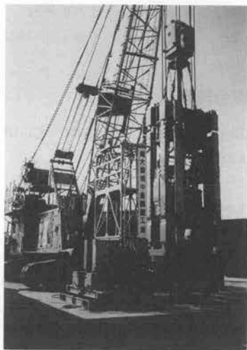
写真1 掘削機械（エレクトロミル掘削機、ベースマシン、機体位置検出装置）
