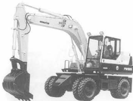
写真-6 KOMATSU PW 100 S-3 B 道路工事仕様ホイール式油圧ショベル
