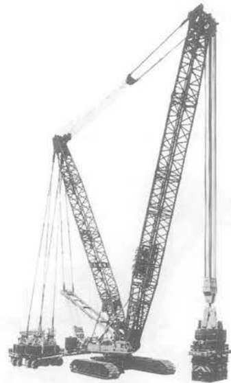
写真-12 神鋼 SL-13000 クローラクレーン (SSHLスタンダード仕様機)
