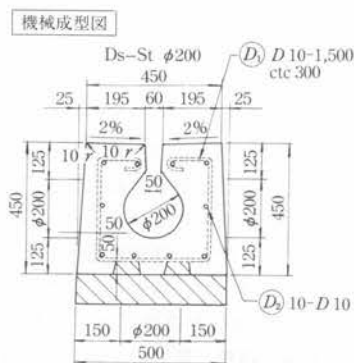
図-3 円形水路断面形状図
