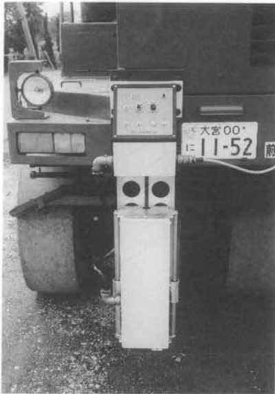
写真-2 測定部取付け状況
