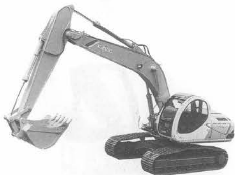
写真-3 神鋼アセラ・スーパーバージョン SK 200 油圧ショベル
