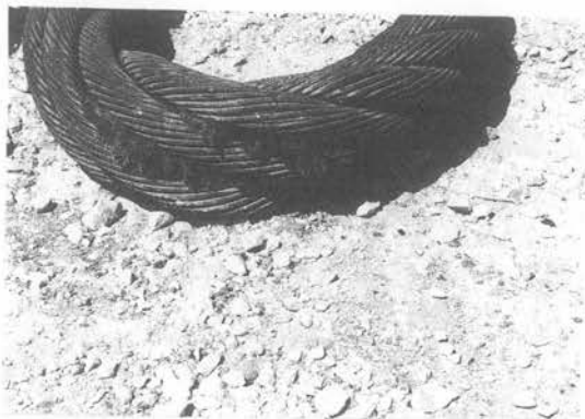
写真一1 形崩れが軽度の100 mm スリングロープ
