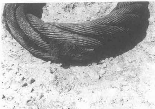
写真-2 形崩れが中程度の100 mm スリングロープ
