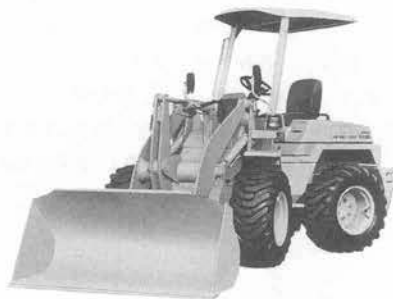
写真-4 KOMATSU WA 50-3 アバンセミニホイールローダ
