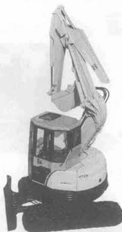
写真-2 日立ランディキッド EX 55 UR 超小旋回ミニショベル
