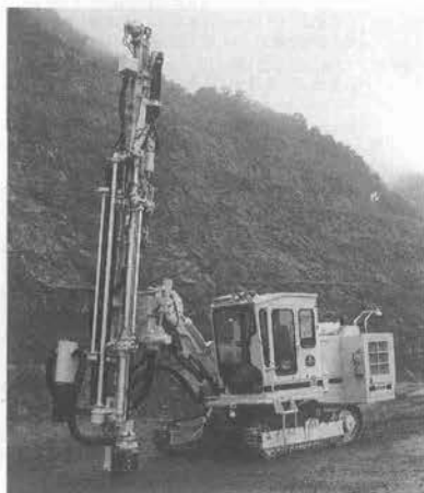
写真-8 東京流機 CDH 912 C 全油圧式クローラドリル
