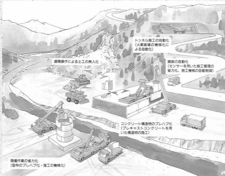
現場施工のロボット化・ プレハブ化 —土木施工の効率化技術の開発
