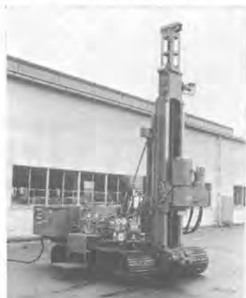
YBM-SS-60地盤改良機
