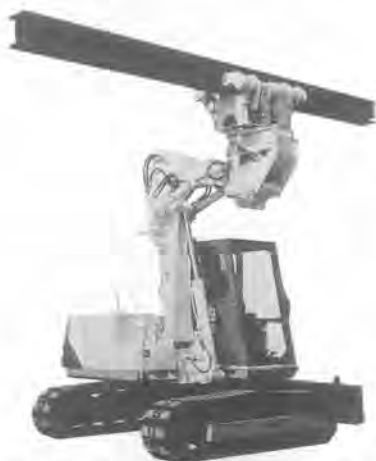
写真-10 神鋼 地下工事作業用H型鋼ハンドリング機
