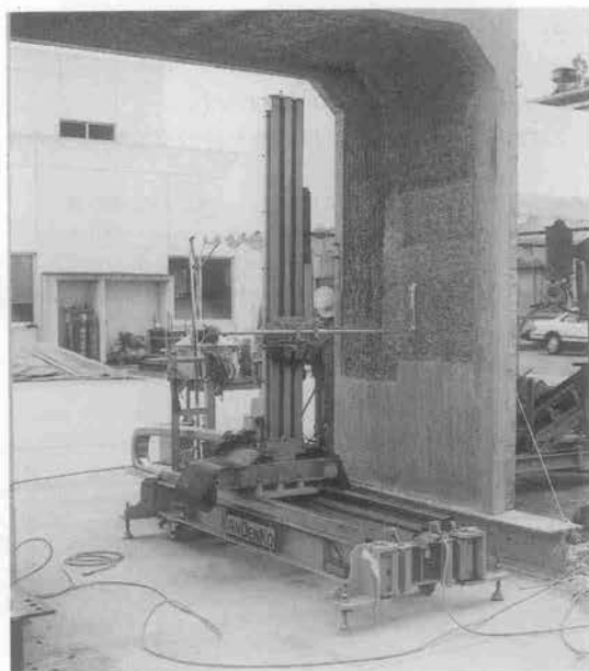
写真-2 吹付ロボット
