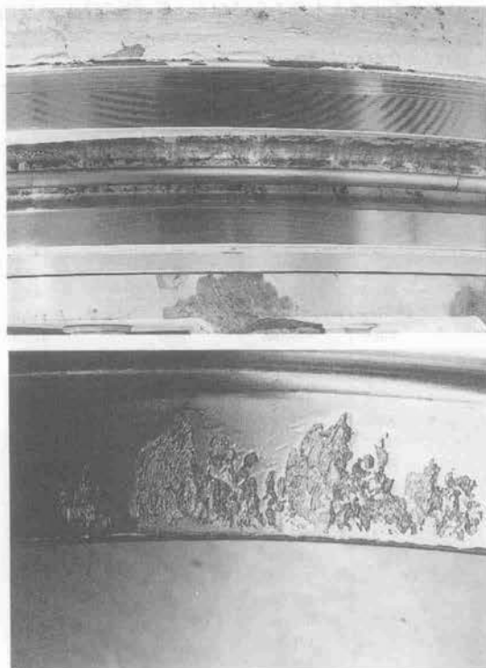
写真-1 軌道面の損傷例 (1) 錆 (上), フレーキング (下)
