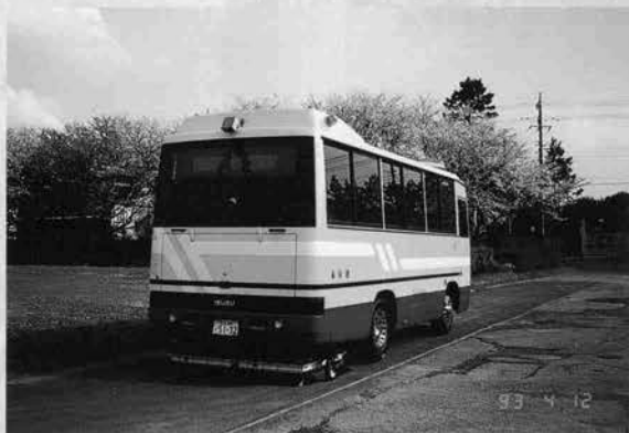
路面下空洞探査車 (計測中)
