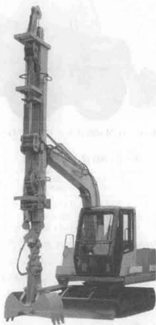
写真-3 住友 SH 60 PC バイブクラム (深礎立坑掘削用油圧ショベル)
