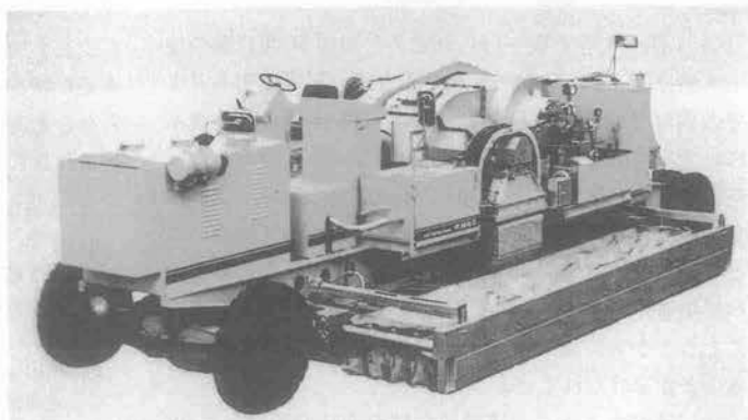
写真一 集中燃焼方式路面ヒータ
