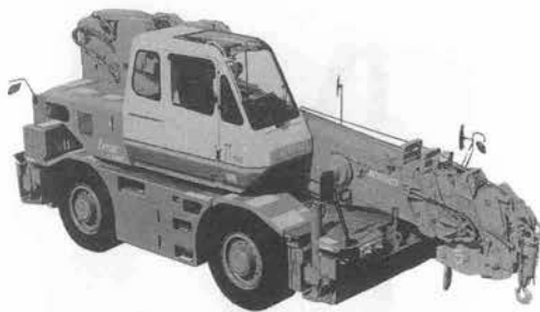
写真-10 神鋼「リンクス」160 シティコンシャスクレーン
